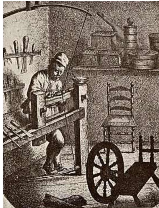
Draaier. De draaibank heeft hier nog een zeer primitieven vorm.
